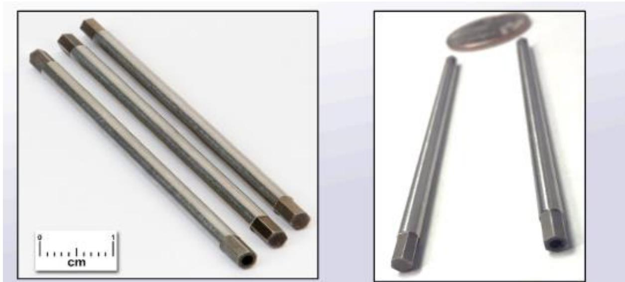
Рис. 4 стержень из сплава Ni и Ti
