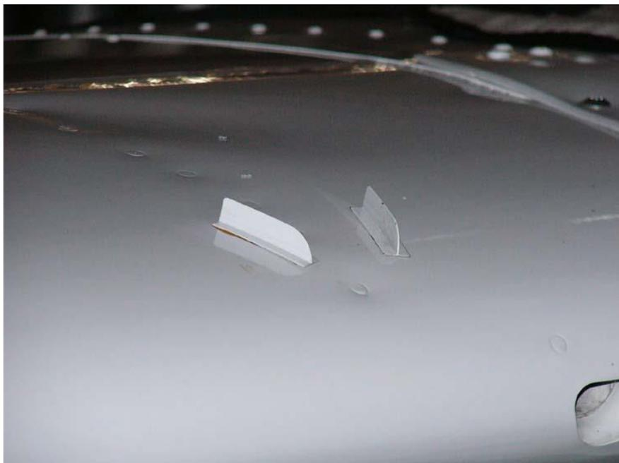
Рис.1 Завихритель на крыле самолёта
