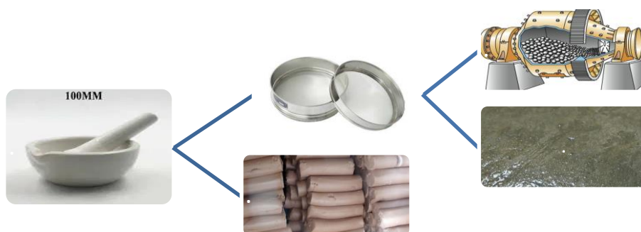
Рис. 1. Технология получения ультрадисперсной керамики.
