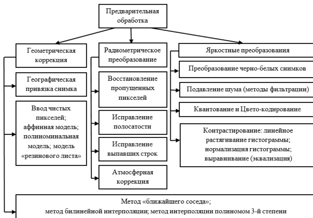
Рис.3. Предварительная обработка многозональных космических снимков
