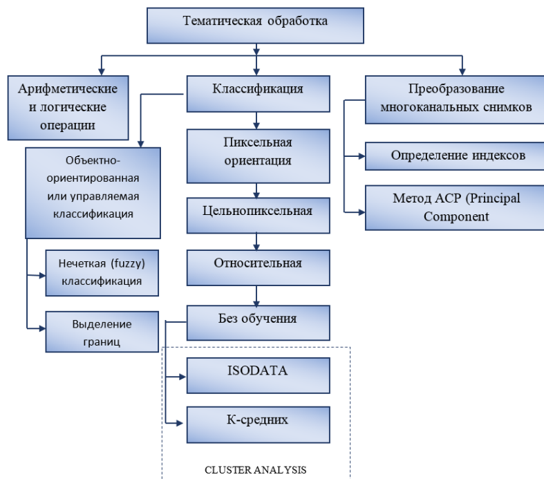
Рис.8. Иерархическая структура методов тематической обработки снимков
