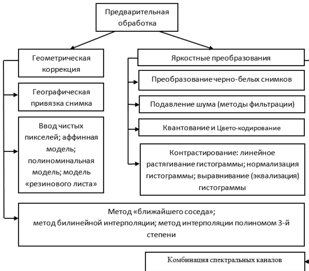
Рис.5. Структурная схема предварительной обработки многозональных снимков
