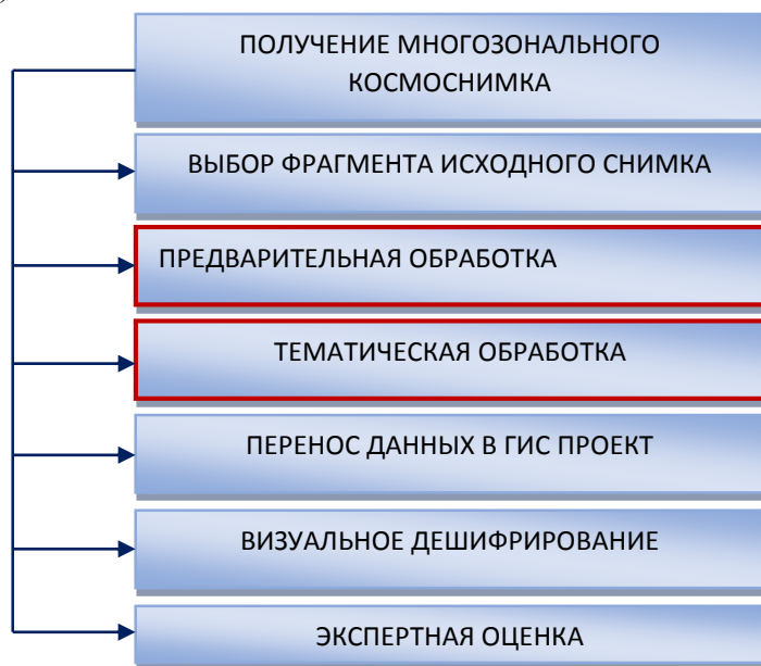
Рис.2. Технологическая схема обработки материалов ДЗЗ
